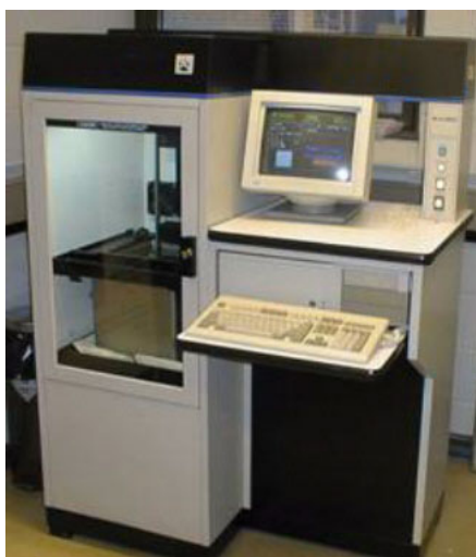
Obrázek 1: První komerční 3D tiskárna SLA-250 2
