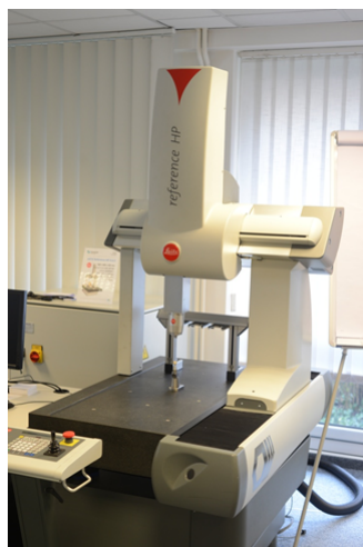
Obrázek 19: Vybraný měřicí stroj LEITZ Reference HP
