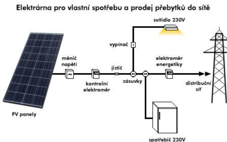
Obrázek 39: Schéma principu fungování fotovoltaiky v našem domě 38
