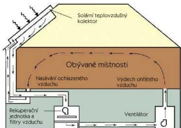
Obrázek 27: Princip teplovzdušného vytápění 27
