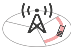
Obrázek 5: Zjištění polohy zařízení metodou CGI+TA
