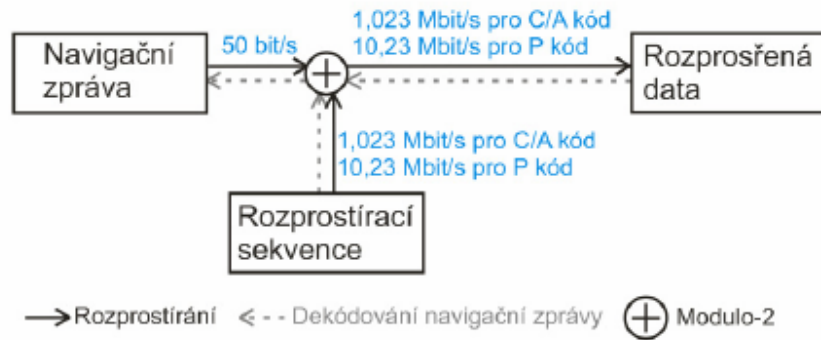
Obr.11: Přenos navigační zprávy pomocí rozprostřeného spektra
